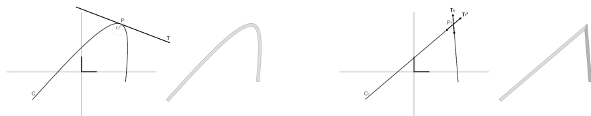
Figure 1. Tangente continue (rayon de courbure minimum). Tangente discontinue (assemblage du matériau).
