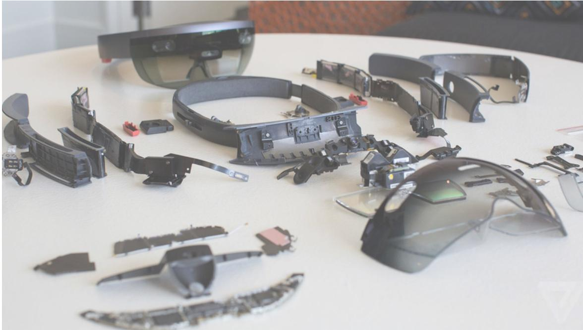
Fig.6 Photographie du casque HoloLens démonté. Source : Google Image
