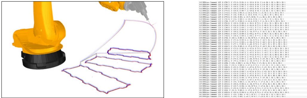
4. Simulation de la trajectoire d'usinage et export du fichier d'instructions au format standard XML.
