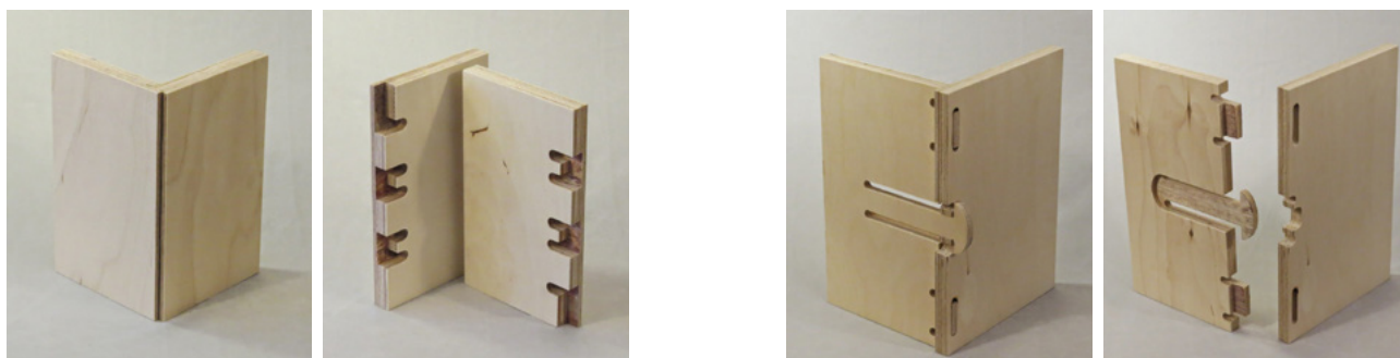
2. Deux exemples d'assemblages innovants réalisés à l'aide d'une machine à commande numérique. Le premier est invisible de l'extérieur tandis que le second, très facilement montable et démontable, impacte beaucoup plus l'esthétique de l'objet. Images : «CNC Cut Wood Joinery» disponible sur mkmra2.blogspot.fr
