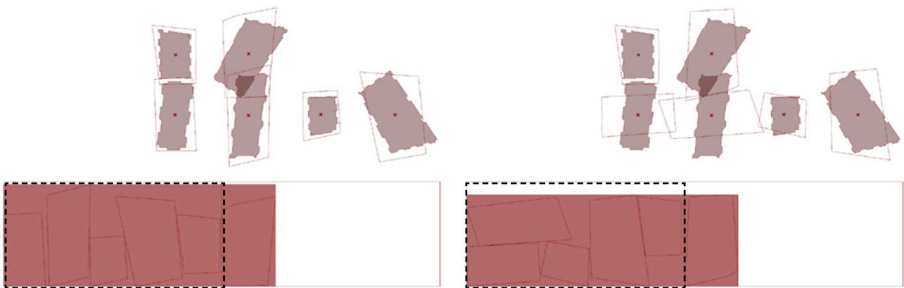
2. On remarque que le plugin Nesting conserve au maximum l'orientation initiale des objets lors du calepinage.
