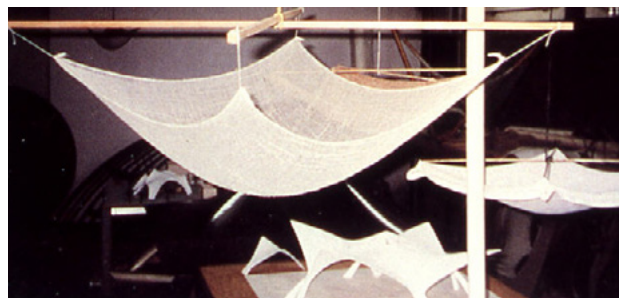
3. Station service à Deitingen sur l'autroute A1 Zurich-Bern par Heinz Isler, 1968. La maquette d'étude a permis de trouver la forme la plus adaptée à donner à la voûte en béton en fonction de la gravité.
