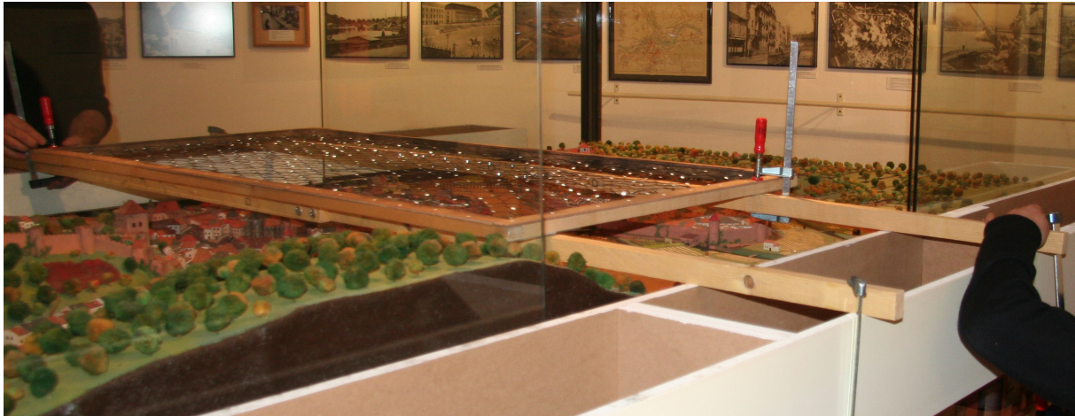
Illustration 18 : L'encombrement que représente le grillage de points de repères est important. Le scanner manipulé à la main accèdera très difficilement aux zones mal orientées
