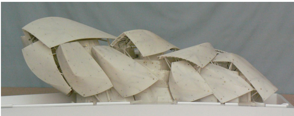
fig.38: 3. Maquette-prototype de la fondation Louis Vuitton, réalisée par frittage de poudre pour étude en soufflerie. (Source : ZOME)
