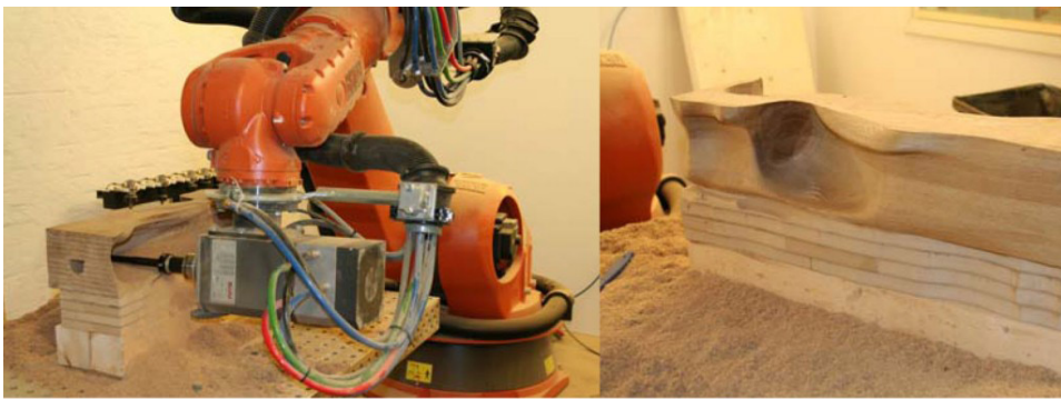
fig.44: Usinage de la maquette finale dans du chêne massif à l'aide d'une fraiseuse pilotée par ordinateur (méthode de fabrication digitale soustractive).
