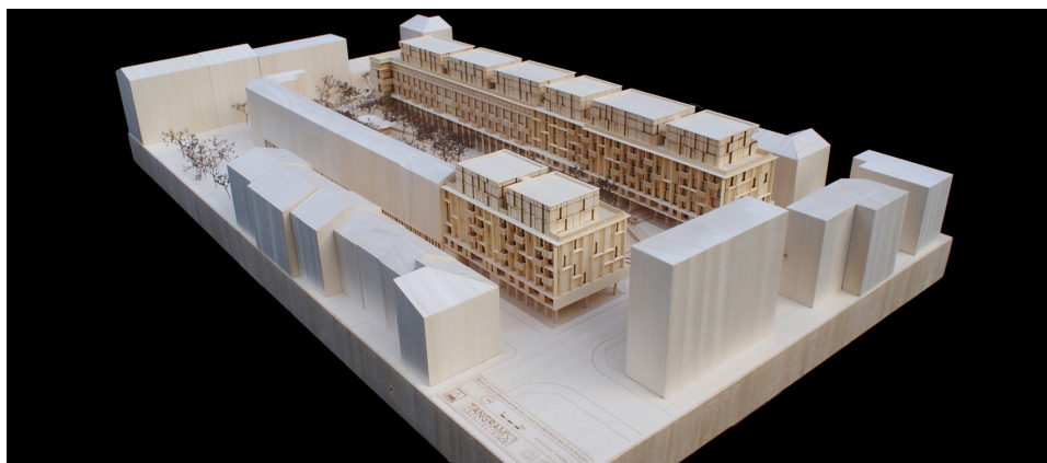
fig.39: Maquette de concours en samba réalisée par découpe laser (projet) et maquettage traditionnel (socle et bâti existant). (Source : Tangram Maquettes)
