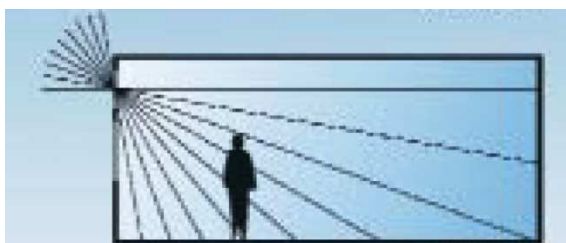
[Figure 21] Comparé à une fenêtré standard le système anidolique renvoit la lumière au fond de la pièce
