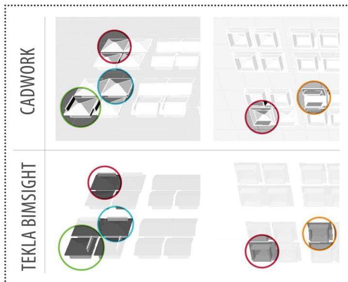
Figure 45 : Visualisations du même fichier IFC sur Tekla Bimsight et sur cadwork
