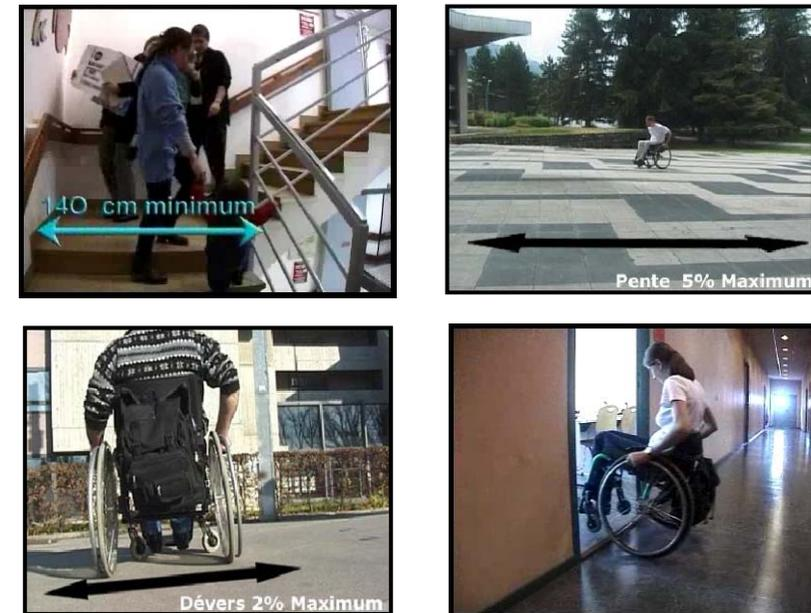
Fig-16 : Données quantitatives et géométriques
