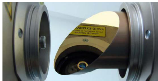
Figure 2-14 : Détail du miroir rotatif
