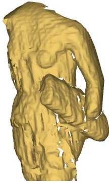
Figure 3-8 : Maillage du nuage de points brut de l’Amazone
