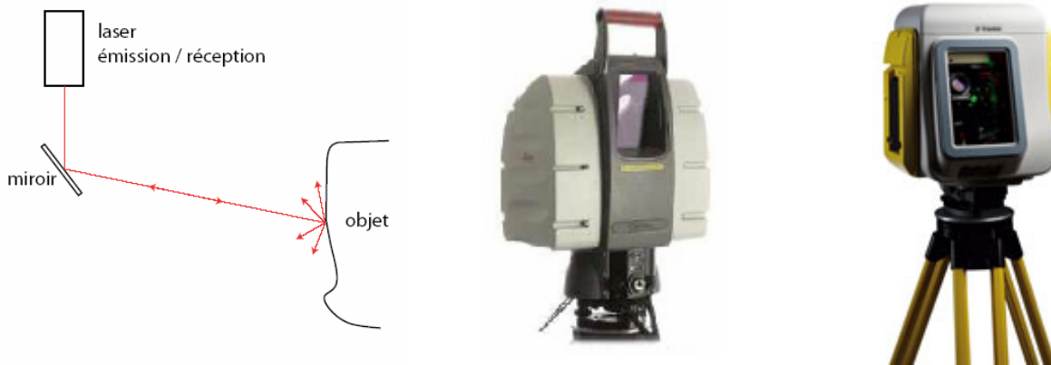
Figure 2-4 : A gauche, principe de la mesure du temps de vol ([MAR01])
