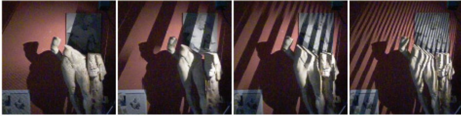
Figure 1-5 : Projection des 4 premières séquences géométriques du scanner ( [AKC06])
