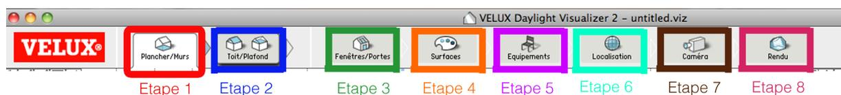
Le logiciel permet de recréer des espaces simples et fermés grâce à de nombreux modules prédéfinis. L'épaisseur et la hauteur des murs peuvent être modifiées (étape 1). Une fois les murs définis, il est possible de choisir un type de toiture (étape 2), des types de fenêtres et de les disposer n'importe où sur les murs (étape 3). Les différentes étapes s'enchaînent, l'étape 4 est le choix des matériaux composant les ouvertures et les différents
