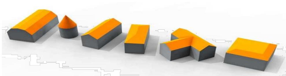
Illustration 15 : Quelques Formes géométriques des toitures
