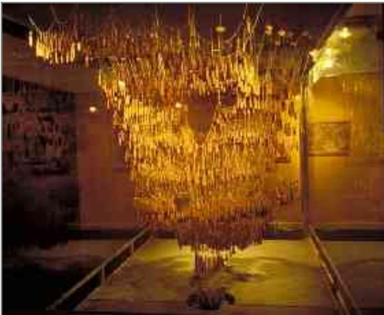
Figure 1. Maquette d'étude des voûtes de la Sagrada Famillia de Antonio Gaudi à Barcelone (1892-1926) élaboré par détermination d'amplitude funiculaire.
