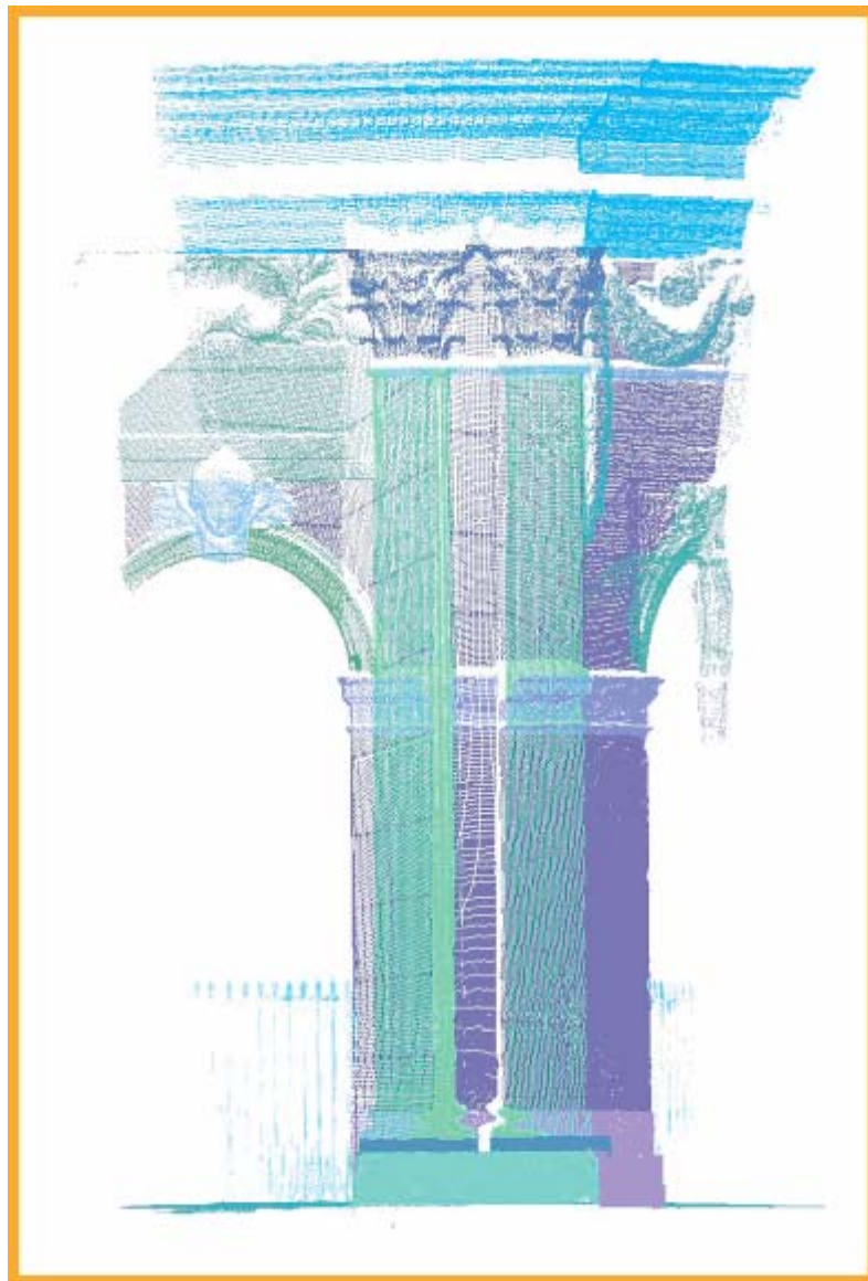
Figure 27 : nuage de points du château d'eau
