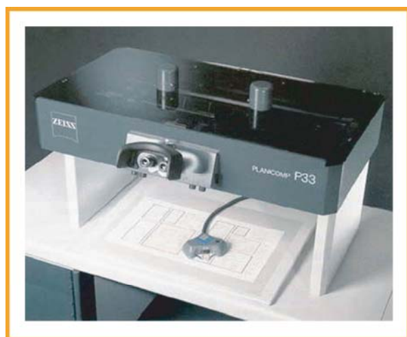
Figure 13 : stéréorestituteur analytique Zeiss Planicomp P33 D'après [IEN02]
