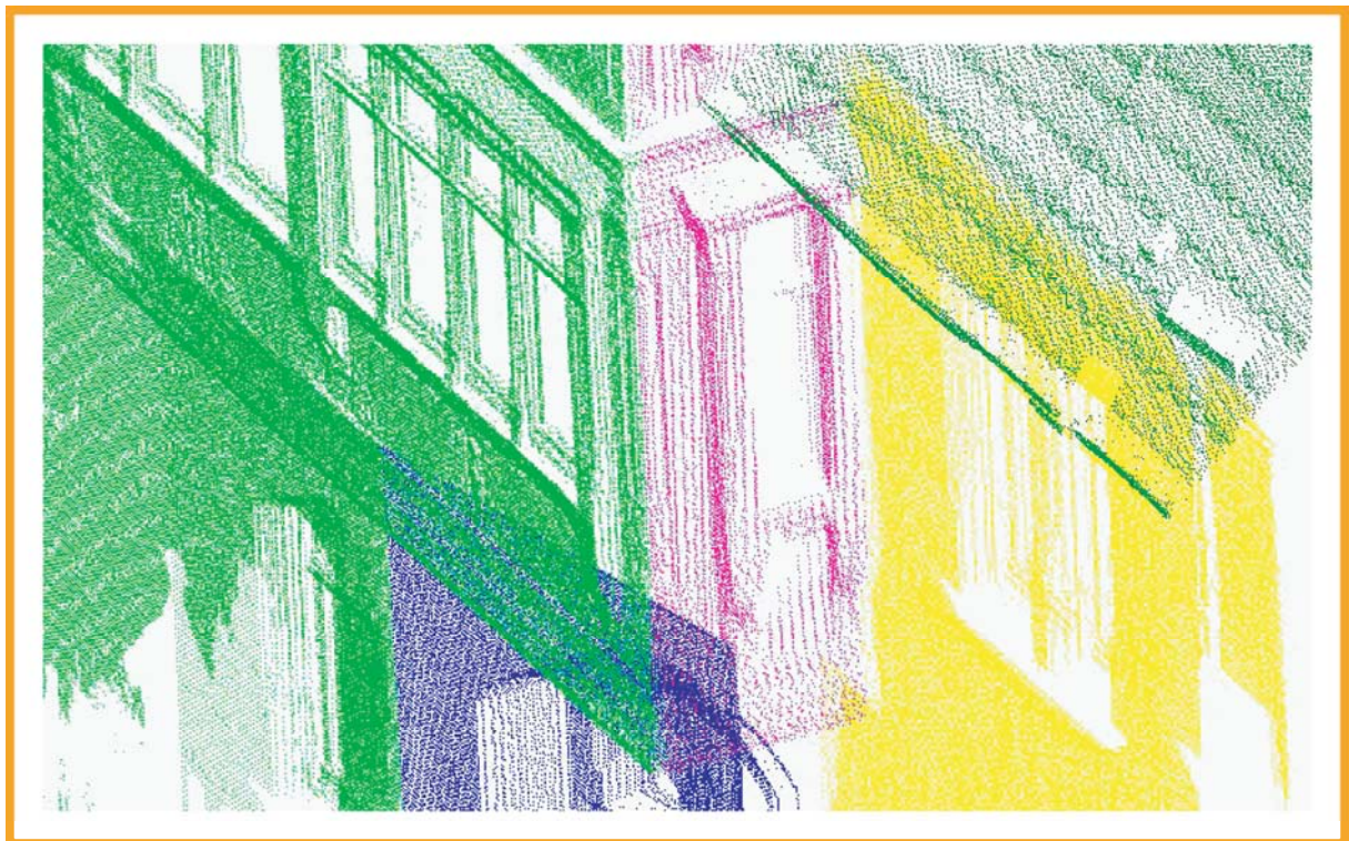
Figure 22 : segmentation d'un nuage de points
