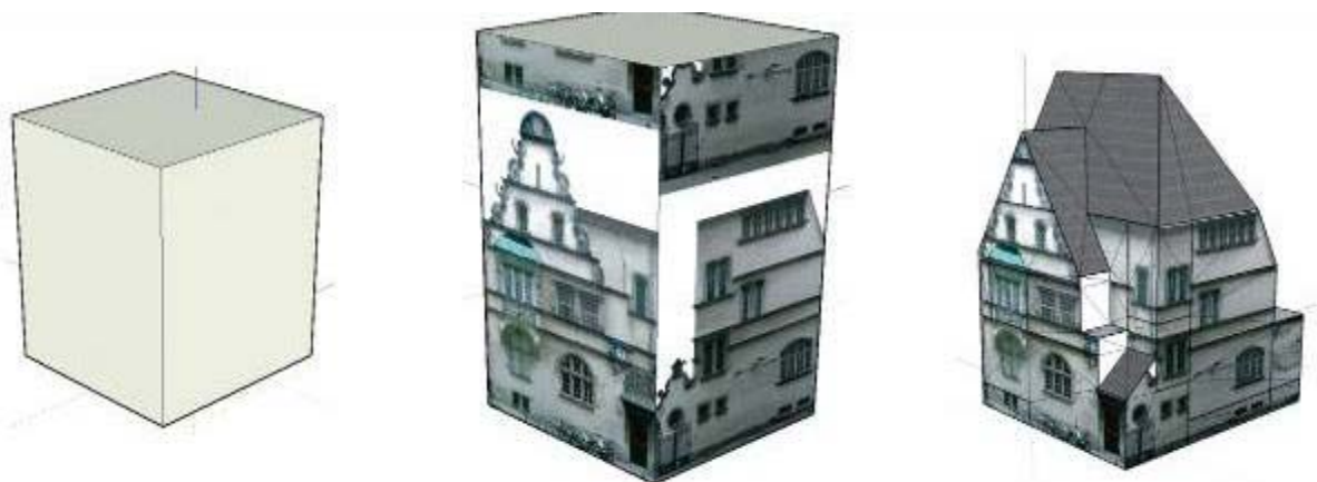
Figure 62 : utilisation de l'ortho-photo préexistante comme aide au découpage des façades
