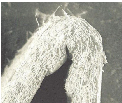
Figure 1.43 - Agrandissement d'un pli effectué sur une feuille de papier. D'après (Trebbi, 2008, p. 26).
