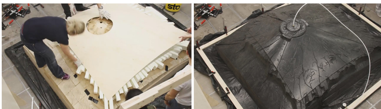
Figure A3.3 - HygroSkin. Mise en forme des modules du pavillon par la technique du moulage sous vide. Achim Menges, 2013. Source : FRAC Centre Orléans.
