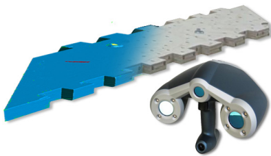
Figure 3.17 - Numérisation d'une des 57 pièces usinées. (EXAscan de CREAFORM®).
