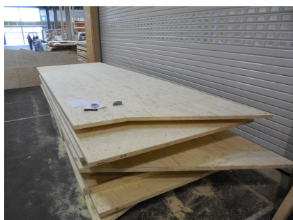
Figure 3.2 - Panneaux de lamibois débités en deux parties. Dimensions des panneaux bruts : 10500 mm x 1800 mm x 40 mm.
