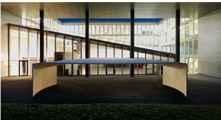
Figure 2.24 - Prototype formé de panneaux de CLT incurvés et assemblés par un système de queues d'aronde. L'ensemble des panneaux a été usiné par une machine à commande numérique. D'après (Robeller et al., 2014).
