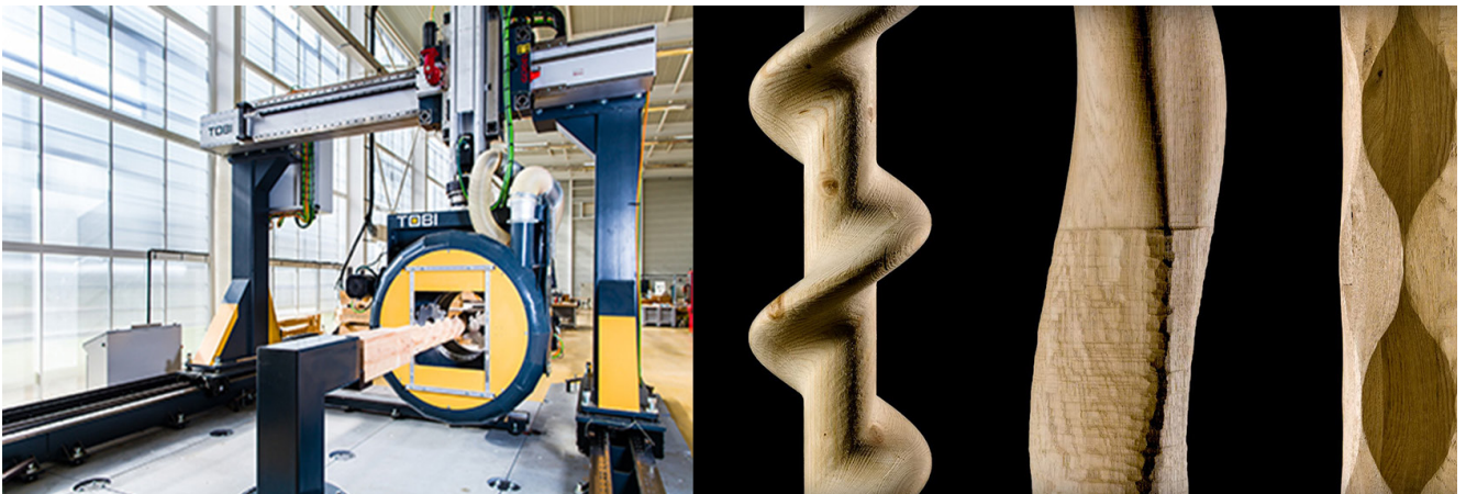
Figure 2.6 - Procédé «TOBI» (Tour à Bois Innovant) permettant un fraisage épicycloïdal multidirectionnel. Société d'Innovation et d'Ingénierie en Machines-Outils (SIIMO).
