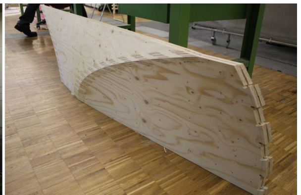
Figure 2.24 - Prototype formé de panneaux de CLT incurvés et assemblés par un système de queues d'aronde. L'ensemble des panneaux a été usiné par une machine à commande numérique. D'après (Robeller et al., 2014).
