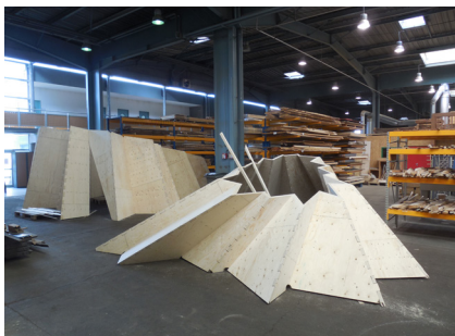
Figure 3.15 - Montage à blanc en atelier : recherche d'éventuelles anomalies.
