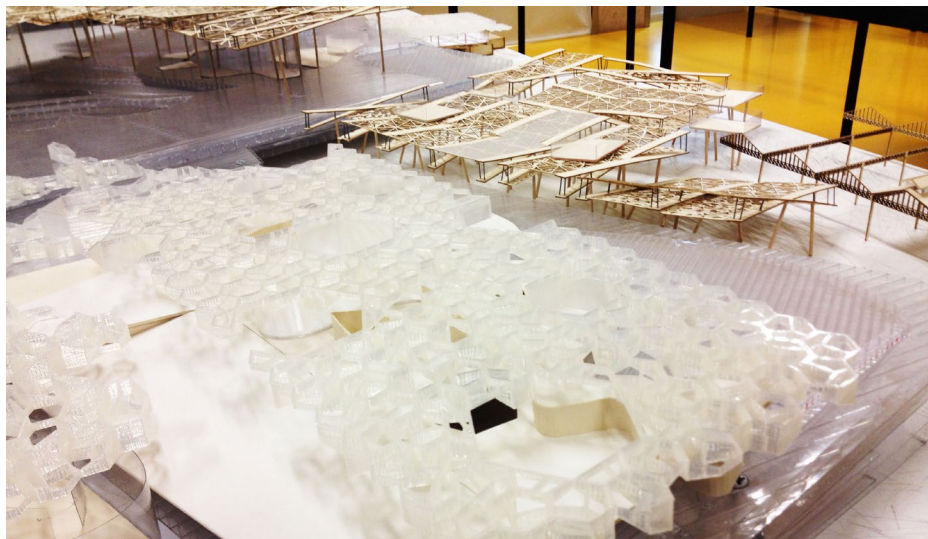
Deux maquettes de PFE pour lesquelles ont été utilisées les techniques de découpe, d'impression 3D, et de maquettage traditionnel
