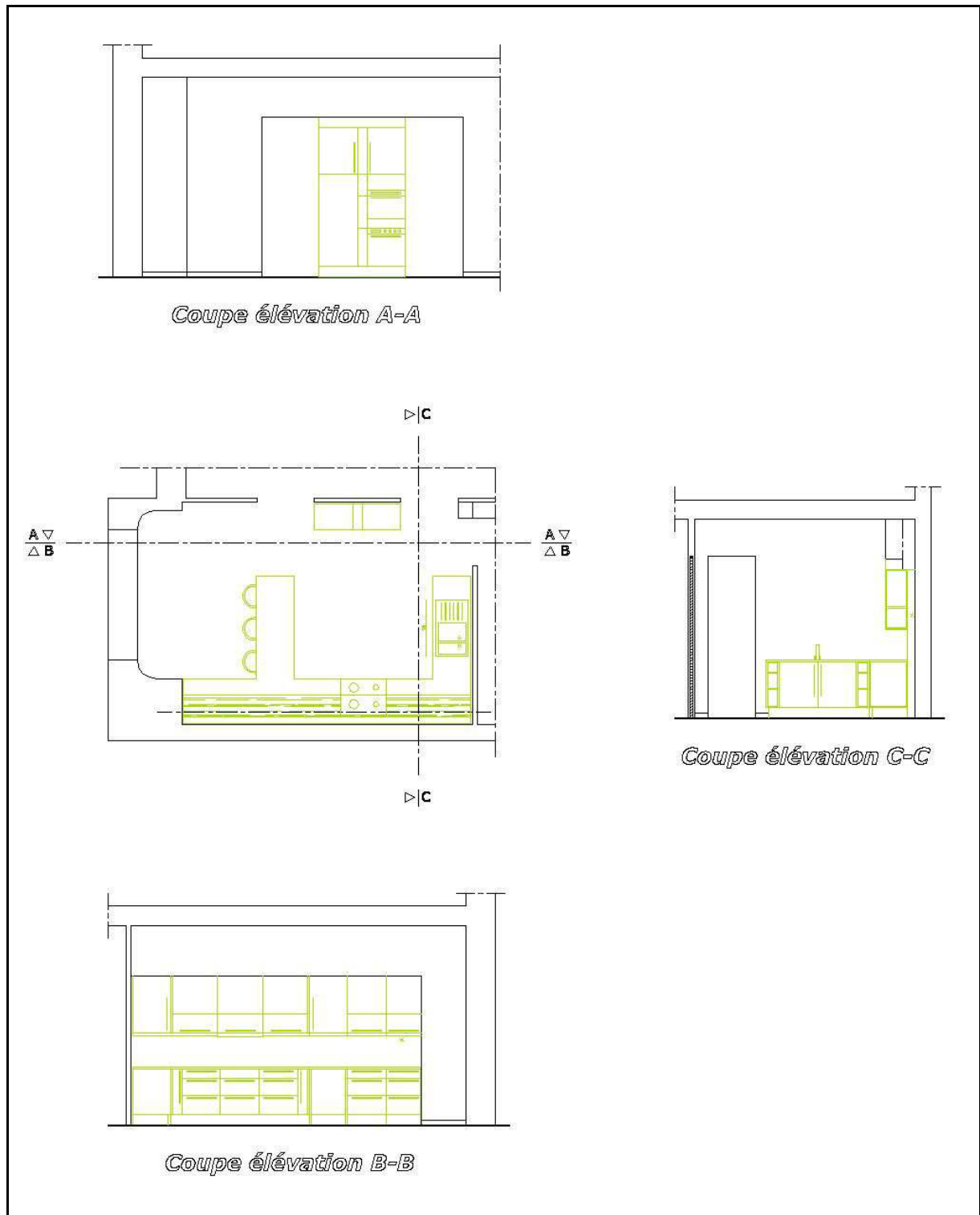
Illustration 33 : Vue en plan et coupes élévations de l'agencement final de la cuisine
