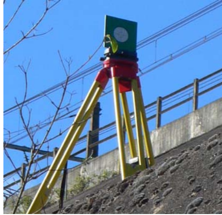
Figure 1.2 Utilisation des cibles pour effectuer le recalage (scanner topographique)
