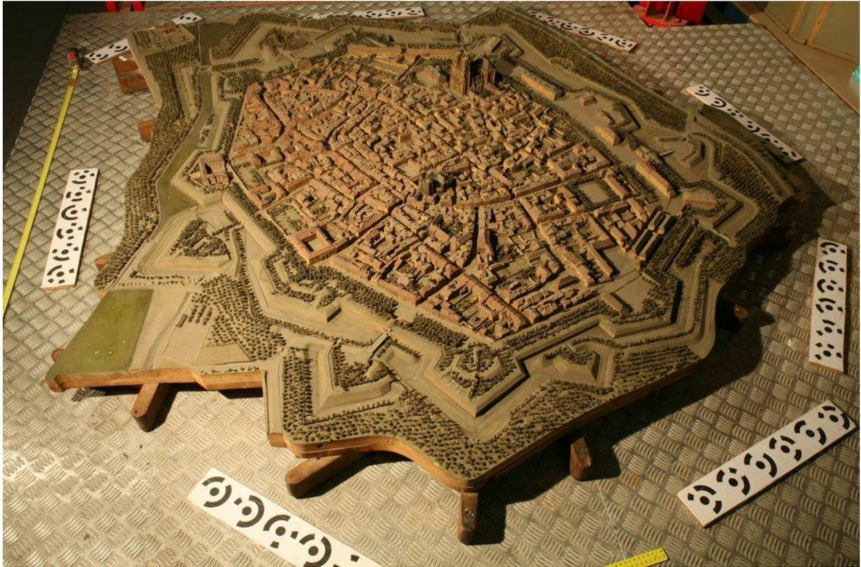
Figure 1 : Table de ville du plan-relief de Toul (2.31m \* 2.23m) lors de la phase d'acquisition par Scan 3D au musée des plans reliefs.
