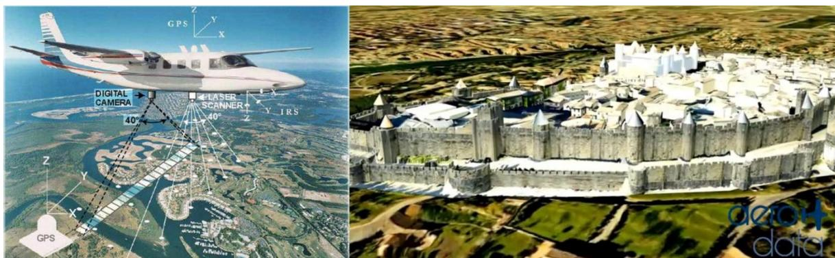
*Figure 8 : La technologie Lidar permet d'obtenir un maillage du terrain, chaque point étant repéré par ses coordonnées GPS. Associé à un système d'acquisition photo et de logiciel d'orthorectification, cette méthode permet la restitution photo réaliste d'objets architecturaux complexes sur des zones très étendues. (<http://www.riesonweb.com>)*
