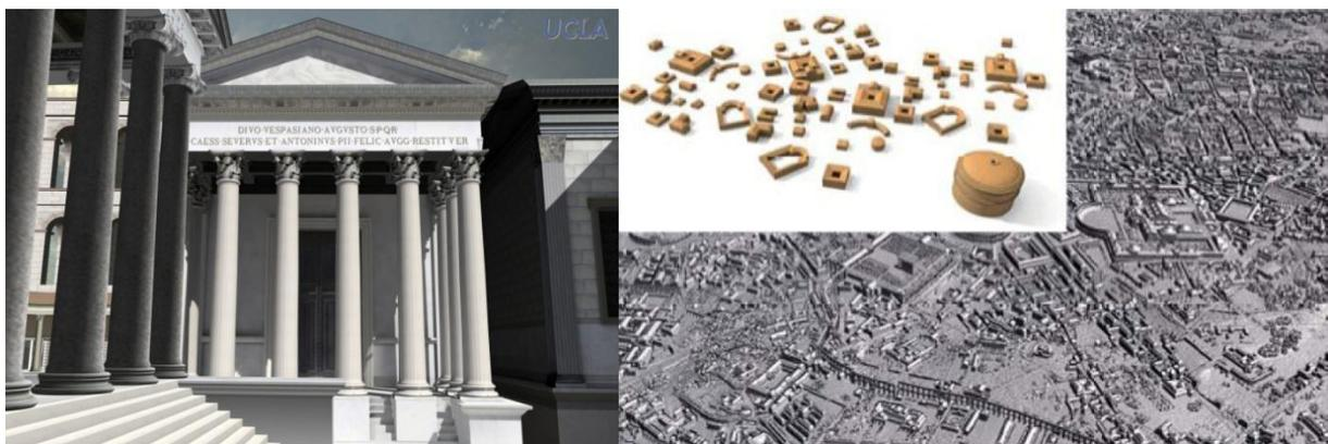
Figure 5 :A gauche :image issue de la modélisation par méthode classique du temple vespalien. A droite : le maillage corrigé issu de la numérisation laser et différents types de volumes utilisés sur CityEngine.(5)
