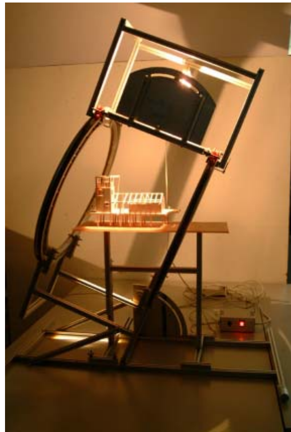
Fig 33. Simulation de la lumière directe avec l'héliodon, Faculté d'architecture, Université de Hong Kong.
