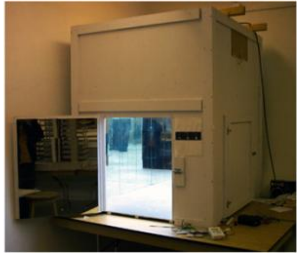
Fig 34. La boîte-miroir. Le ciel artificiel du GRAP, Université Laval, sous la supervision de Jean-Claude Leclerc, et Claude Demers.
