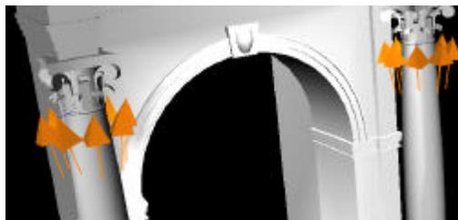
Figure 2: L'affectation d'un réseau circulaire à l'une des colonnes a créé un deuxième réseau identique sur la deuxième colonne.
