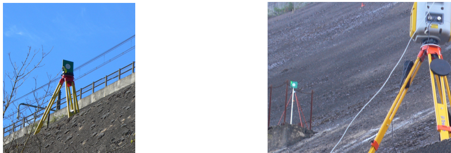
Figure 18 : Cible montée sur trépied (à gauche), cible montée sur canne (à droite)
