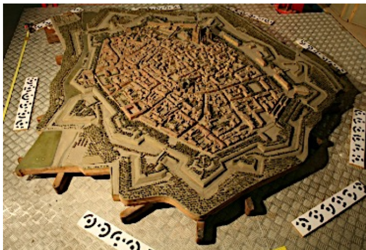
Figure 5 : La table du Plan -Relief de Toul (2,31m*2,23m) lors de la phase d'acquisition par photogrammétrie. (Photo Map Crai)
