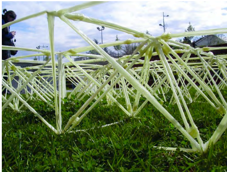
Recherche sur des structures légères en matériaux composites. Etude effectuée aux Grands Ateliers, animée par Luc Boulais . (document transmis par l'architecte).
