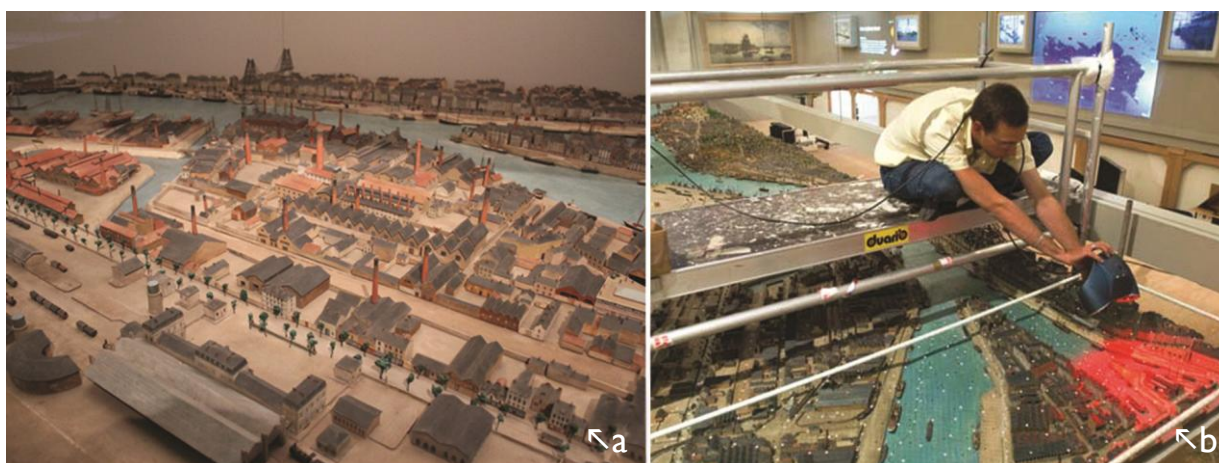
Figure 31. Détail de la maquette (a) et acquisition tridimensionnelle (b) par capteur laser à triangulation REVscan (Creafom).
